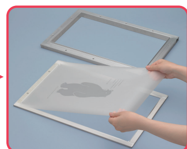
③ 枠張りして完成
